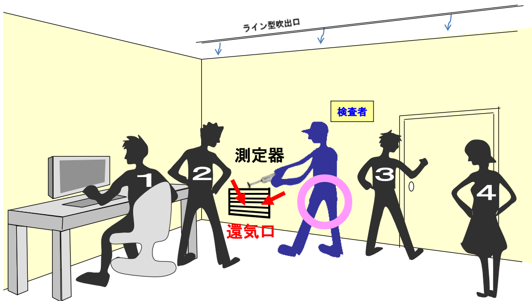
設計定員 4 名の居室の二酸化炭素の含有率の測定による検査 (良い例)
