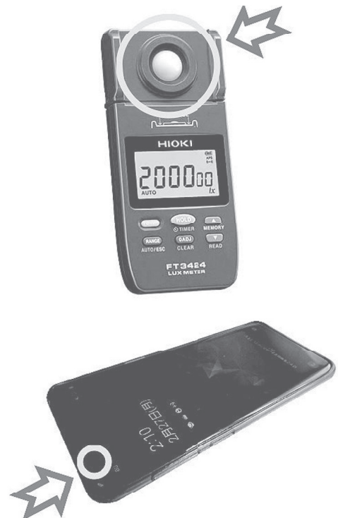
照度計とスマートフォンの照度センサーの受光面の違い
