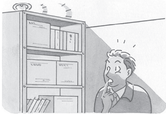
図-2 非常用の照明装置の物品放置の状況
